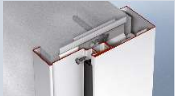
Gegenzargen-Profil 2 der Zarge durch die Dichtungsnut mit Profil 1 verschrauben und mit der Türdichtung überdecken
