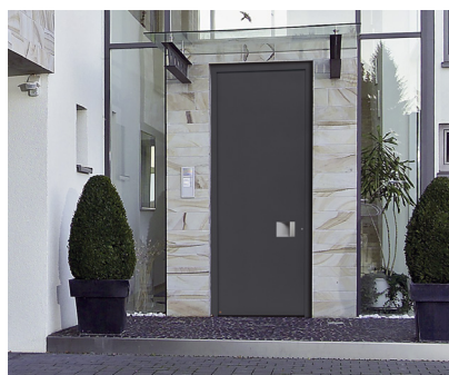
Алюминиевая входная дверь Hörmann ThermoCarbon с коэффициентом теплоизоляции UD до 0,47 Вт/(м 2 ×К), достигаемым за счет композитного профиля створки с карбоновым стекловолокном, и с защитным оснащением RC4. Теперь эта модель поставляется высотой также до 3 м
