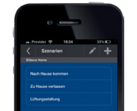
Для повторяющихся ситуаций, как «приход домой», в которых, например, сначала должны открываться въездные ворота, а затем гаражные, в приложении Hörmann App можно создать так называемый «сценарий». С помощью лишь одного нажатия клавиши все время одни и те же действия выполняются автоматически вместо их выбора по отдельности
