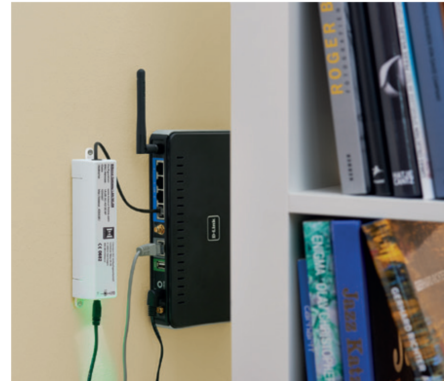
Принадлежность Hörmann: шлюз BiSecur Gateway соединяется с маршрутизатором дома и практически сразу готов к эксплуатации
