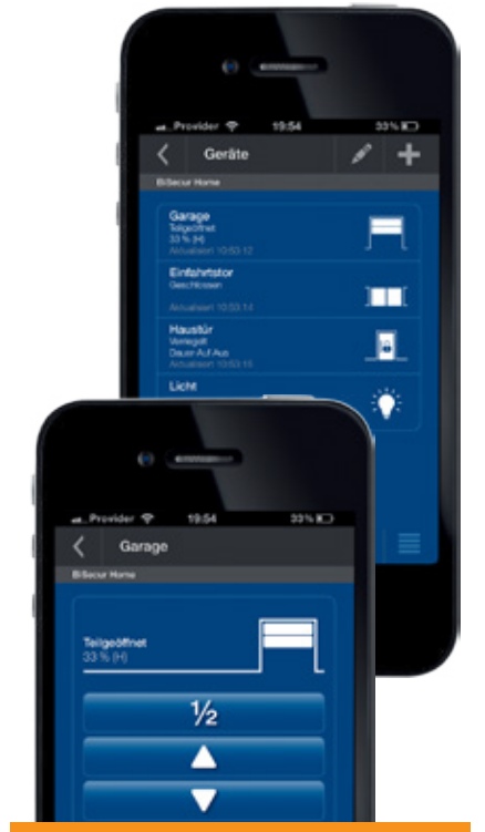
В приложении Hörmann App с помощью символов показывается положение установленных ворот и дверей, а также освещения
