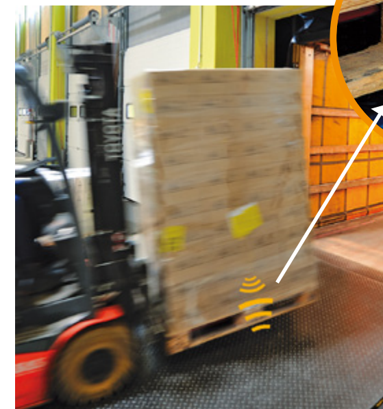
Автоматическая регистрация передвижения груза во время проезда по перегрузочному мосту
