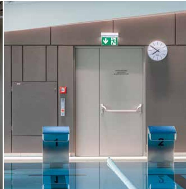
На двухстворчатых дверях устанавливаются две ручки-штанги. Если боковой элемент не важен для обеспечения необходимого размера прохода в свету, то хватит одной ручки.
