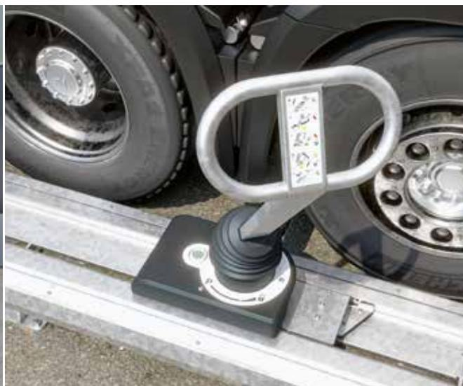
Только при прямом контакте с шиной автомобиля поступает разрешающий сигнал на погрузку-разгрузку.
